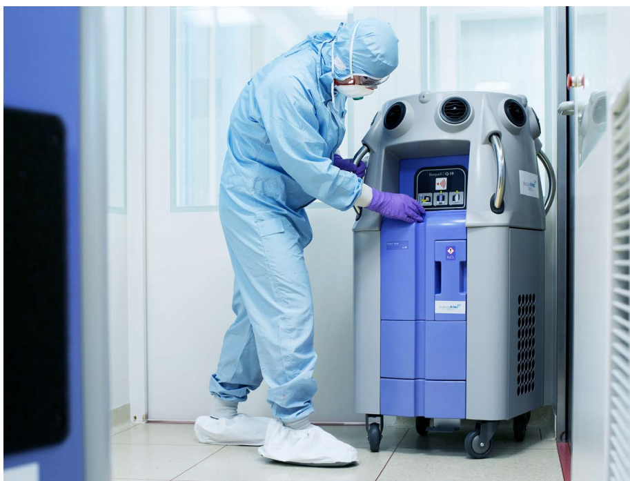
Die automatisierte Raumdekontamination mit H 2 O 2 ist im Vergleich zur manuellen Wischdesinfektion besser reproduzierbar. (Bilder:ENZLER Hygiene AG)
